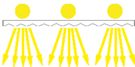
Diffuseur Prismatique = Flux lumineux dirigés
