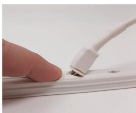
**7/** Pour déconnecter le connecteur, tourner celui-ci à 90°. Poser le doigt sur le câble perforé au dessus du connecteur (pour éviter l'arrachement), puis déconnecter le connecteur en tirant sur celui-ci (ne pas tirer par le câble).
