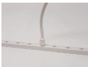
**5 /** Une fois le connecteur partiellement inséré, le redresser pour que celui-ci pénètre le câble en totalité.
